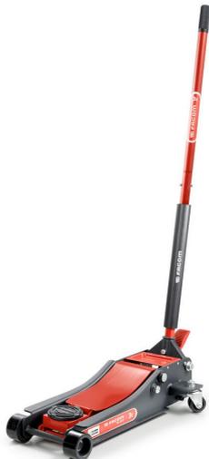
• Ideal para vehículos con chasis bajo, o equipados de protectores de bajos. • Capacidad de carga: 3 t. • Altura máxima de elevación: 533 mm. • Altura mínima bajo el chasis: 100 mm. • Pedal de aproximación rápida, doble pistón. • Regulación de velocidad de descenso. • Suministrado con protección de caucho en la pletina de acero. • Ruedas de poliuretano, ruido reducido. • CE Norma EN1494-ASME-PASE.
