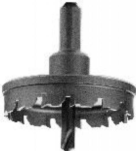
La ejecución plana (altura de la herramienta 8 mm) es adecuada para superficies planas de hasta 4 mm de espesor. La ejecución profunda (altura de herramienta 35 mm) está concebida para la utilización en superficies abombadas y materiales brutos.
